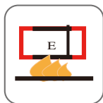
Circuit Integrity IEC 60331-23/BS 6387(Optional)
